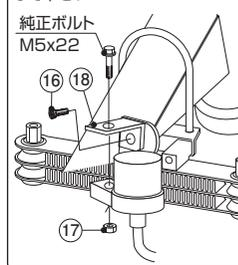
ハーネス、ケーブル類はフレーム横に移動させ、タイラップでフレームに固定。
