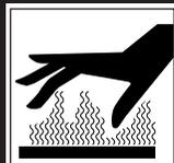
エンジン作動中、作動後のエンジンオイルは高温状態の為、十分に冷してから (表面は低温でもオイルは高温につき注意) 作業を開始して下さい。
