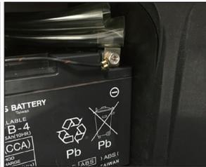
i-Map本体はトランク内に設置する為、④i-Map変換コネクター及びバッテリーマイナス端子用の通し穴をバッテリーカバーに加工してください。
