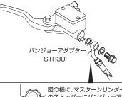
図の様に、マスターシリンダー のストッパーにバンジョーア ダブターを突き当てた状態で オイルボルトを指定トルクで 締め付ける。
